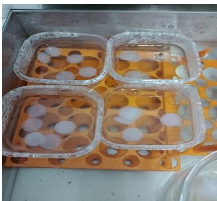
Figura 6 – Aspecto macroscópico das membranas de CB produzidas, em quadruplicata, por K. hansenii ATCC 23769. (Fonte: Próprio autor)
