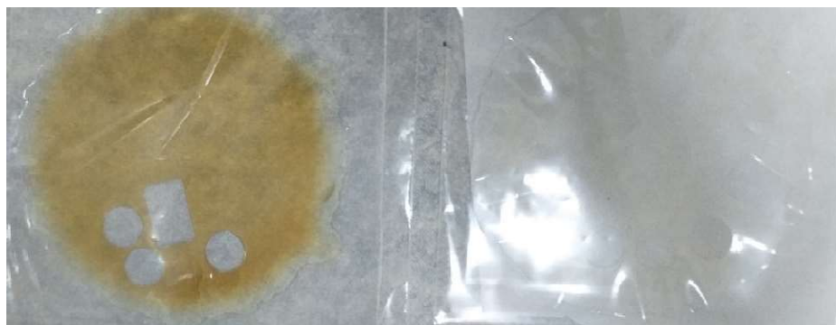
Figura 29- Imagens representativas de amostras dos filmes da PU sintetizada impregnados com Ag-NPs nas concentrações de 800 ppm (mais amarelada) e 200 ppm (mais clara) cortados para ensaios microbiológicos e físico-químico (DRX).
