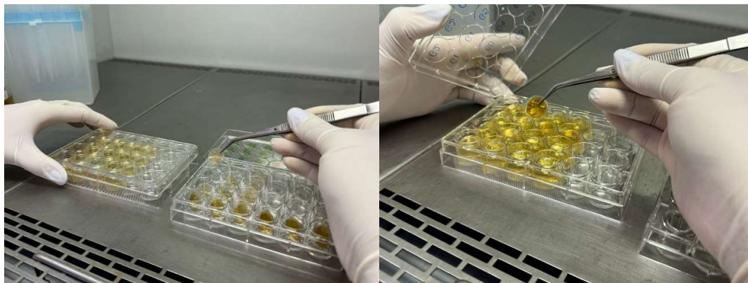
Transferência dos espécimes (discos de WBPU/Ag-NPs) para a placa de 24 poços
