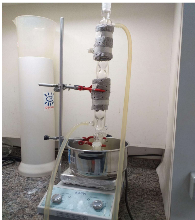
Figura 1: Síntese de Ag-NPs em sistema de agitador magnético utilizando o condensador para evitar evaporação do solvente.
