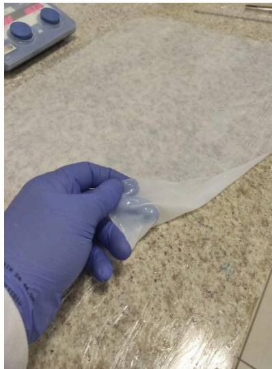
Figura 2: Manta purificada e hidratada de celulose bacteriana.
