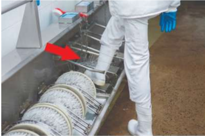
Foto 15 - Instalação para higienização dos funcionários
