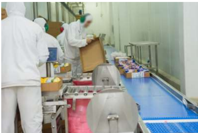
Foto 13 - Encaixotamento e etiquetagem dos miúdos já embalados
