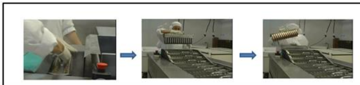
Figura 10: Exemplo do manuseio dos extratores de picolé na picoleteira.
