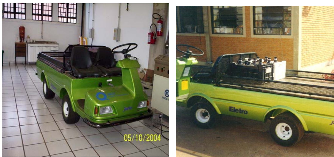
Figura II.15 - Veículo elétrico de 36 volts, 2 HP com capacidade de transporte para 900Kg pertencente ao IQSC utilizado no transporte de resíduos químicos até o Entreposto ao LRQ.
