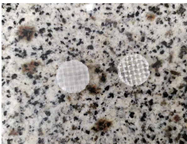
Figura 7. PLA impresso por impressão 3D em forma de scaffolds
