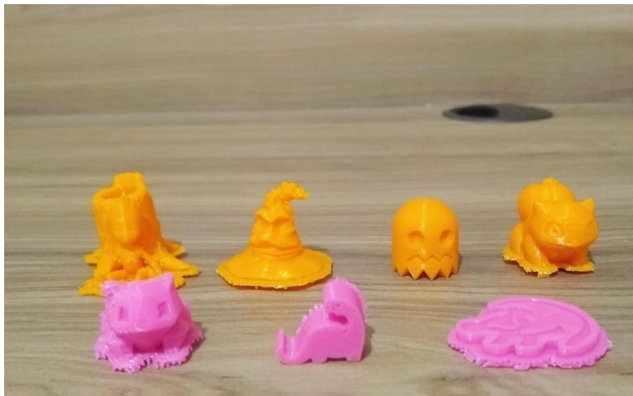
Figura 6: Impressão 3D pela técnica FDM
