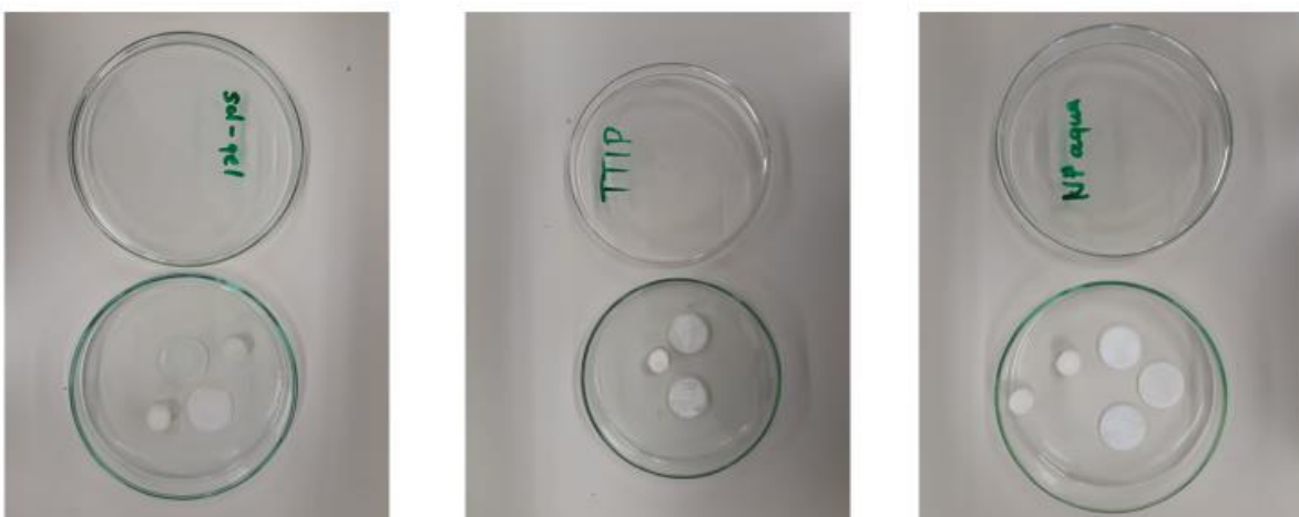
Figura 4.6 – Aspecto visual do PLA modificado com \text{TiO}_2
