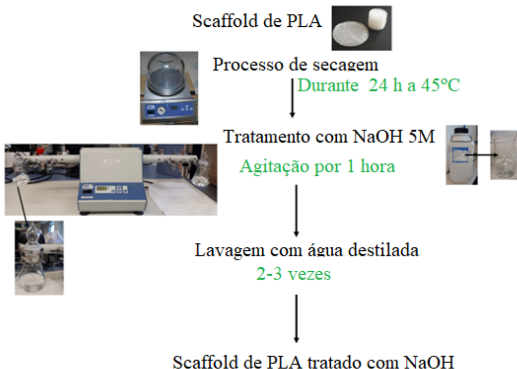
Figura 4.4 – Preparação do scaffold de PLA com NaOH.
