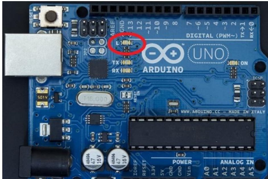
Figura 13: Arduino UNO com o LED integrado circulado
