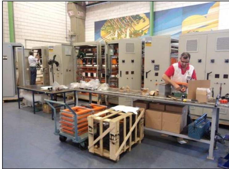
**FIGURA 31:** Montagem de Filtros de Harmônicos Sintonizados Automáticos de Baixa Tensão.
