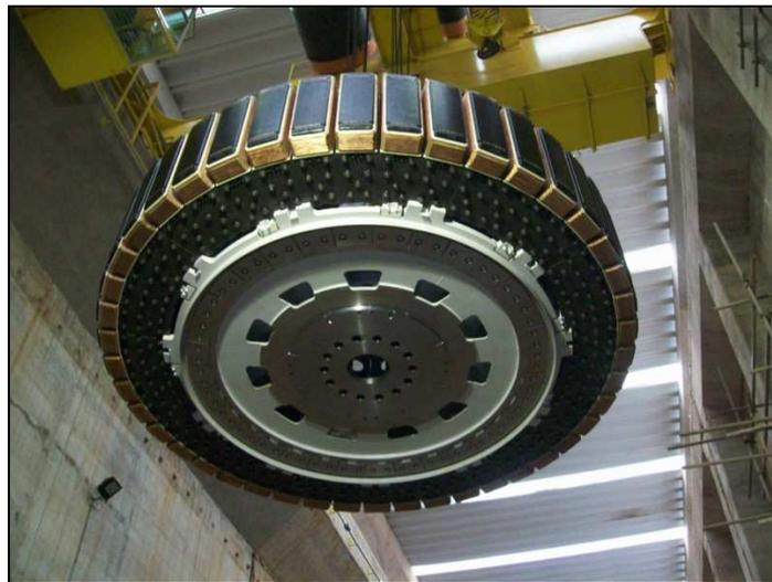
**FIGURA 26:** Rotor para Usinas Hidroelétricas.
