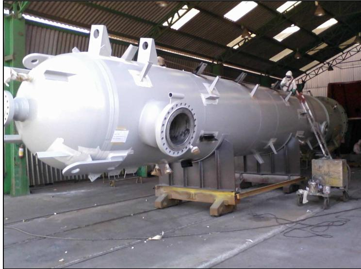
**FIGURA 40:** Processo de Pintura de um Vaso de Pressão.
