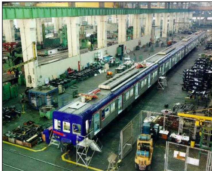
**FIGURA 30:** Metro em Processo de Montagem.
