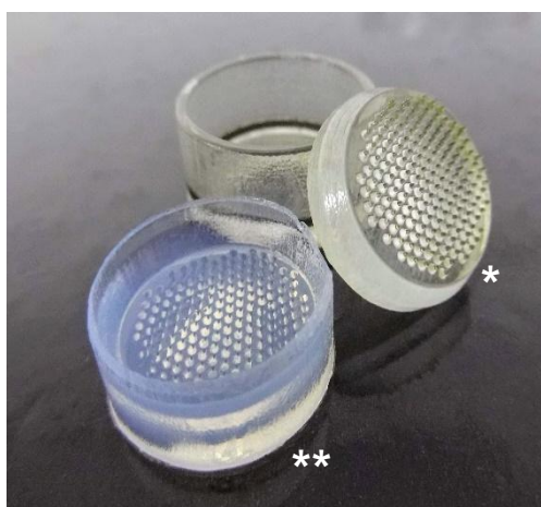
Figura 12 - Fotografia do contramolde (*) e do molde de agarose (**) contendo os micropoços de cultivo celular para formação dos EMs.
