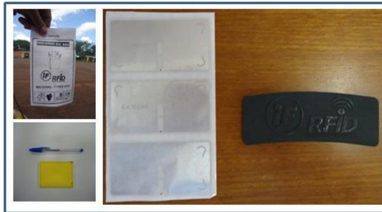
Figura 25- Evolução dos modelos de chip RFID a serem fixados na alça do bag.
