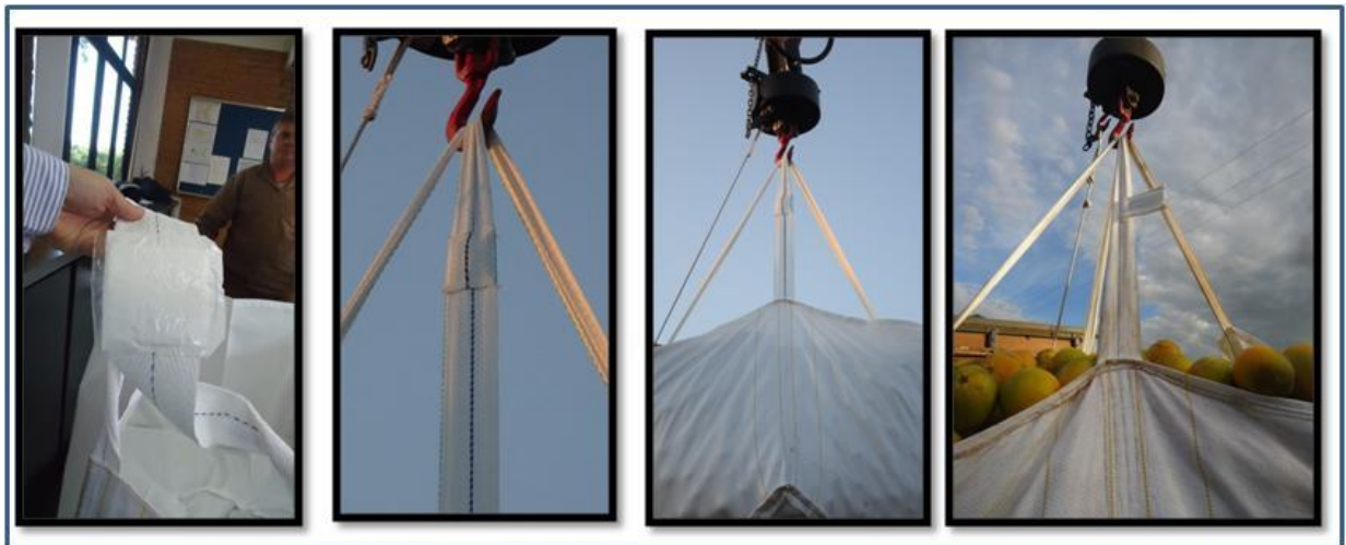
Figura 26- Evolução das formas de fixação do chip RFID na alça do bag.
