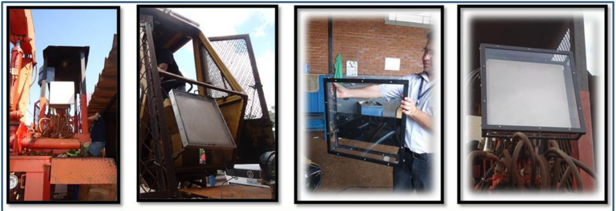
Figura 29 - Evolução da fixação e proteção da antena de leitura do chip de RFID.
