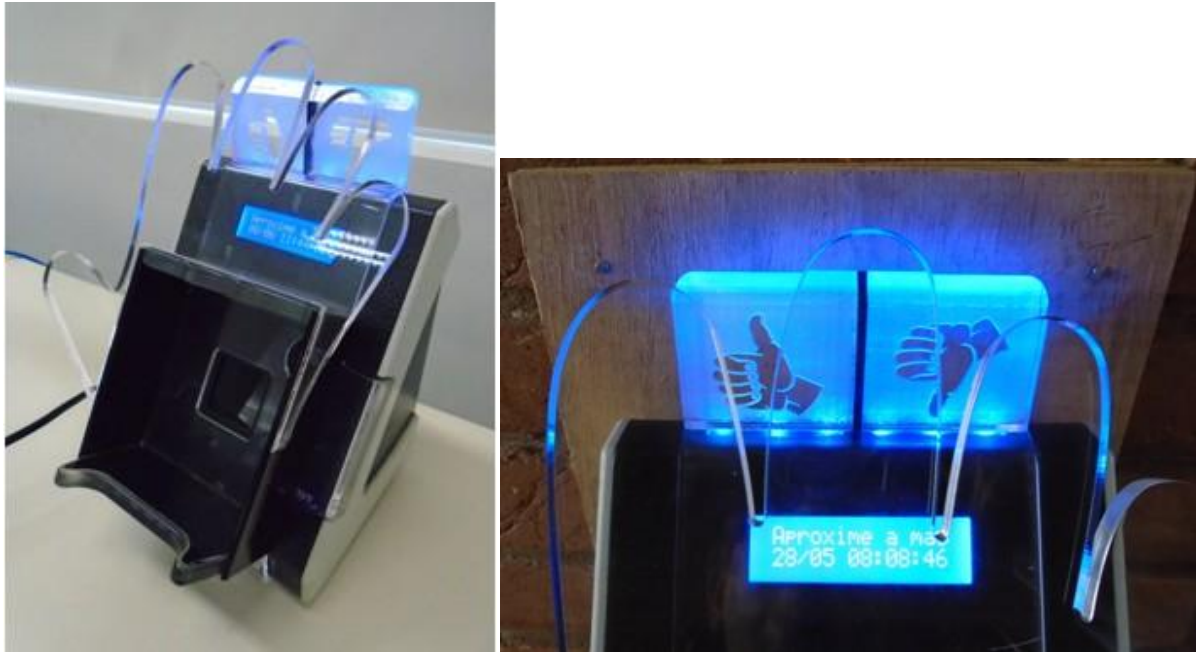
Figura 23 - Quarta geração do leitor de identificação biométrica.
