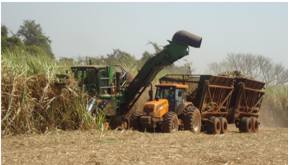
Figura 2 Máquina colhedora acompanhada do transbordo.
