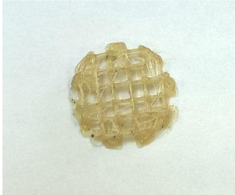
Figura 23: Scaffold impresso em uma impressora 3D FDM utilizando o filamento PHB/GUM 5.
