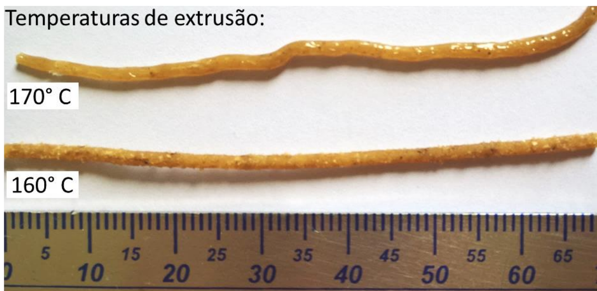
Figura 14: Filamentos PHB/GUM 1 temperatura de extrusão de 170° C e 160° C.
