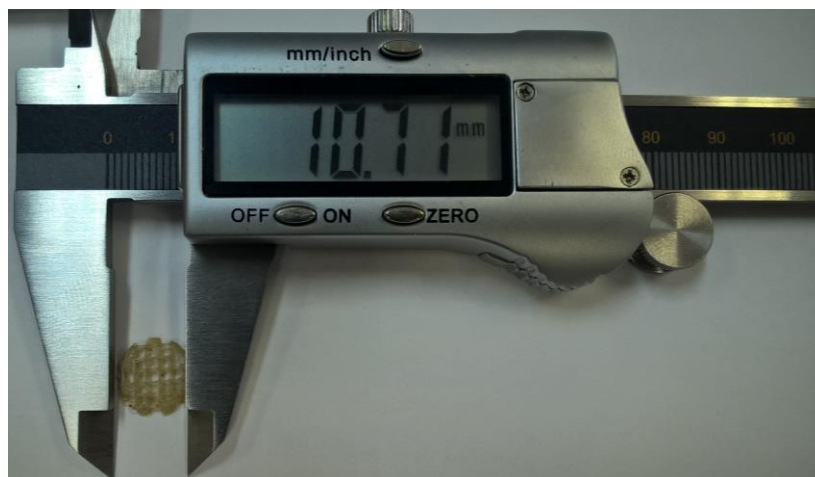
Figura 22: Diâmetro do scaffold impresso em uma impressora 3D FDM utilizando o filamento PHB/GUM 5.
