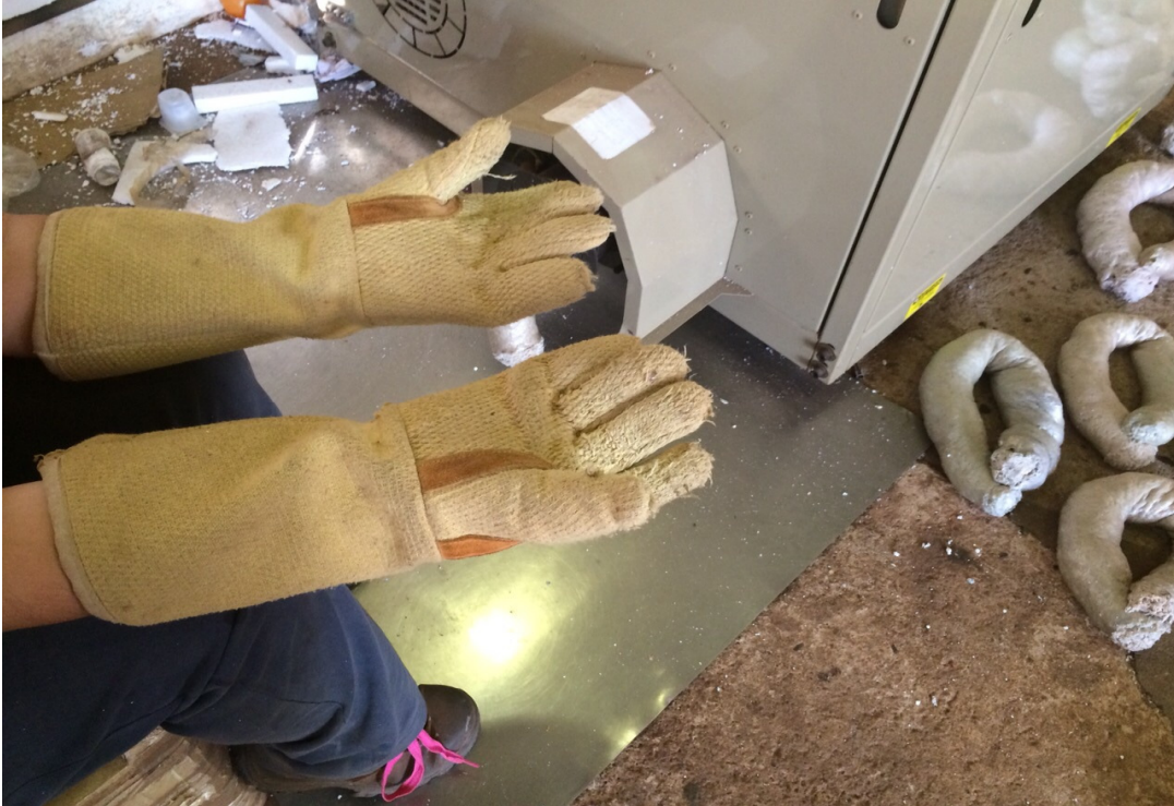
Figura 6: Luvas utilizadas para manipular máquina de derretimento de isopor, 2015
