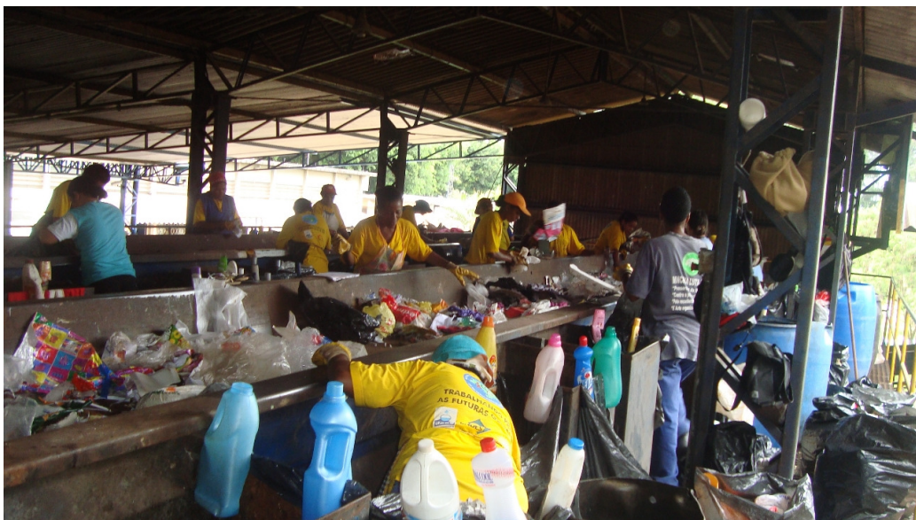
Figura 3: Processo de separação dos materiais coletados.
