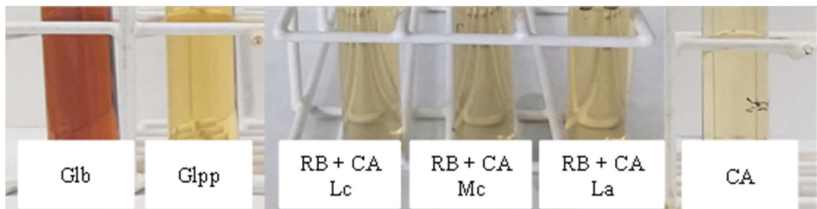
Figura 12 – Glicerol purificado pelo método C em resinas básicas: (RB + CA Lc) resinas básicas do Limão cravo + carvão; (RB + CA Mc) resinas básicas da mistura cítrica + carvão (RB + CA La) resinas básicas da Laranja + carvão (CA) carvão ativado.
