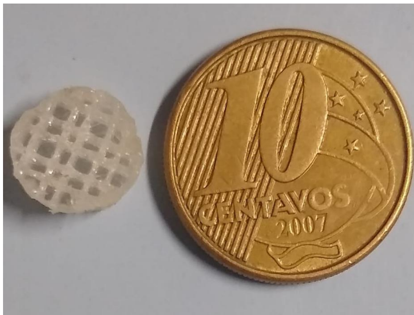
Figura 6- Scaffold de polímero PLA em comparação com moeda.
