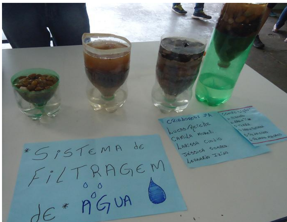
Figura 63 – Filtros de água confeccionados pelos alunos na disciplina de Química
