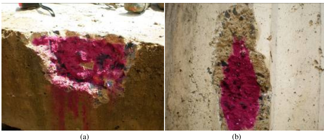
Figura 7 (a e b) avaliação de carbonatação numa cinta inferior externa e um pilar externo.
