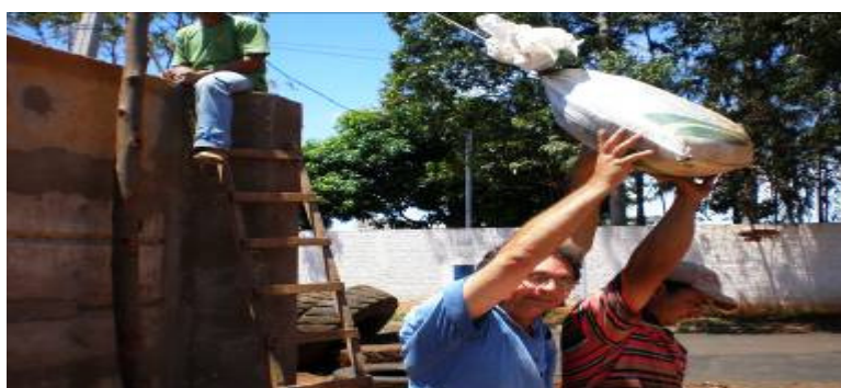
Figura 3 – Ensaio de impacto de corpo mole no lado externo da parede
