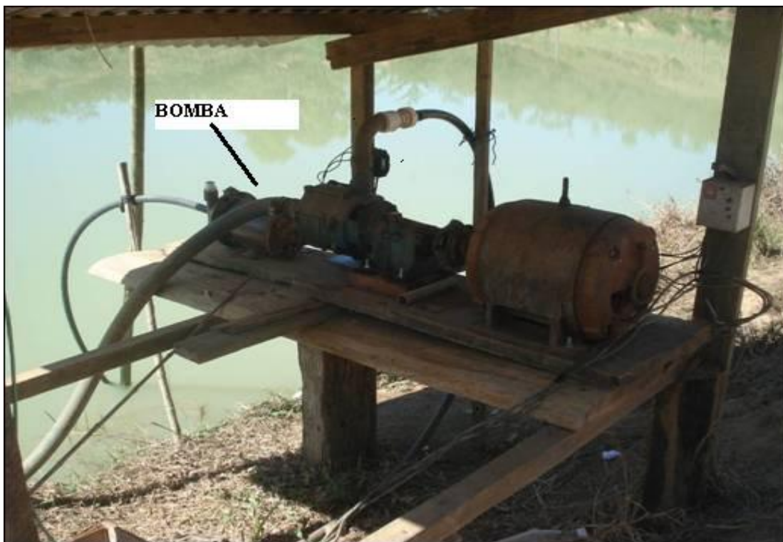
Figura 58 - Bomba utilizada para irrigação do projeto piloto no Distrito de São Dalmácio no município de São Roque do Canaã, ES em 2007, 2008 e 2009
