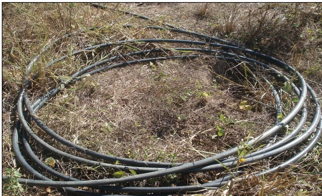
Figura 59 - Mangueira preta rústica de 2 polegadas utilizada para transporte da água até o projeto piloto no Distrito de São Dalmácio, município de São Roque do Canaã, ES, em 2007, 2008 e 2009
