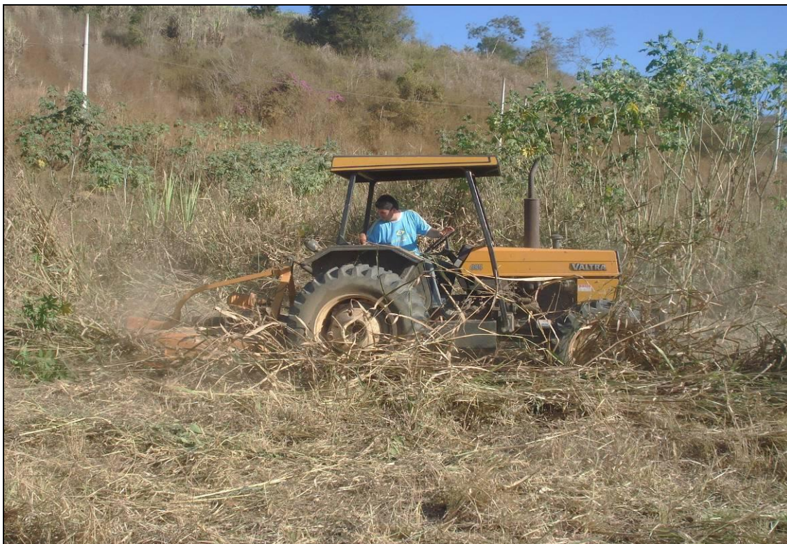
Figura 39 - Roçadeira automática utilizada para capina, substituindo o trabalho manual devido a sua grande agilidade
