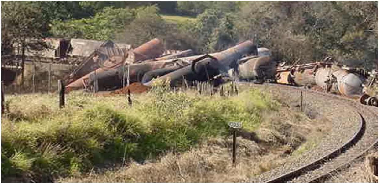
Figura 2- Descarrilamento Trem Sobre a Ponte do Córrego Alegria.
