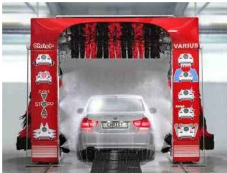
Figura 5 – Lavagem em túnel.
