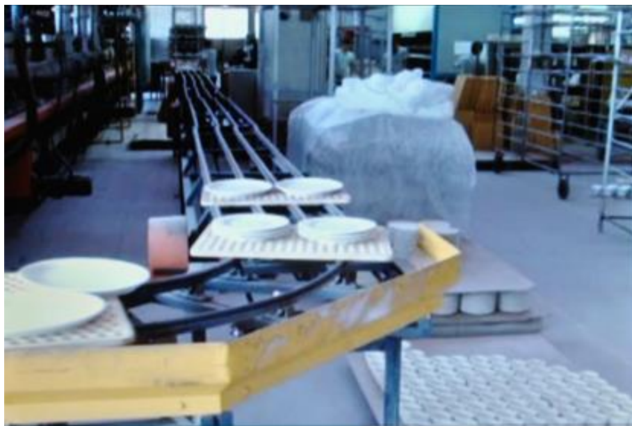
Figura 3.32 – Primeira Queima: Ilustração do retorno das peças ao ponto de retirada e alimentação no forno. Fonte: Empresa objeto do estudo, (2011).
