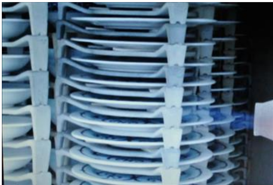
Figura 3.46 – Terceira Queima: Ilustração das peças dentro do forno para a queima do Decalque. Fonte: Empresa objeto do estudo, (2011).
