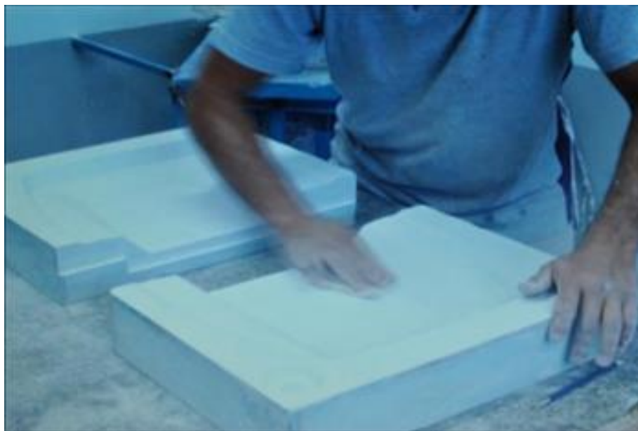
Figura 3.14 – Departamento de Modelagem e Estamparia: Fabricação do molde para prensagem. Fonte: Empresa objeto do estudo, (2011).
