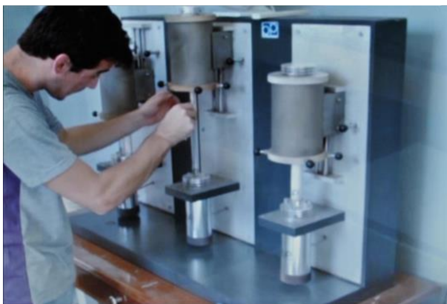
Figura 3.9 – Departamento de Qualidade: Dilatômetro. Ensaio de dilatação Massa x Esmalte. Fonte: Empresa objeto do estudo, 2011.
