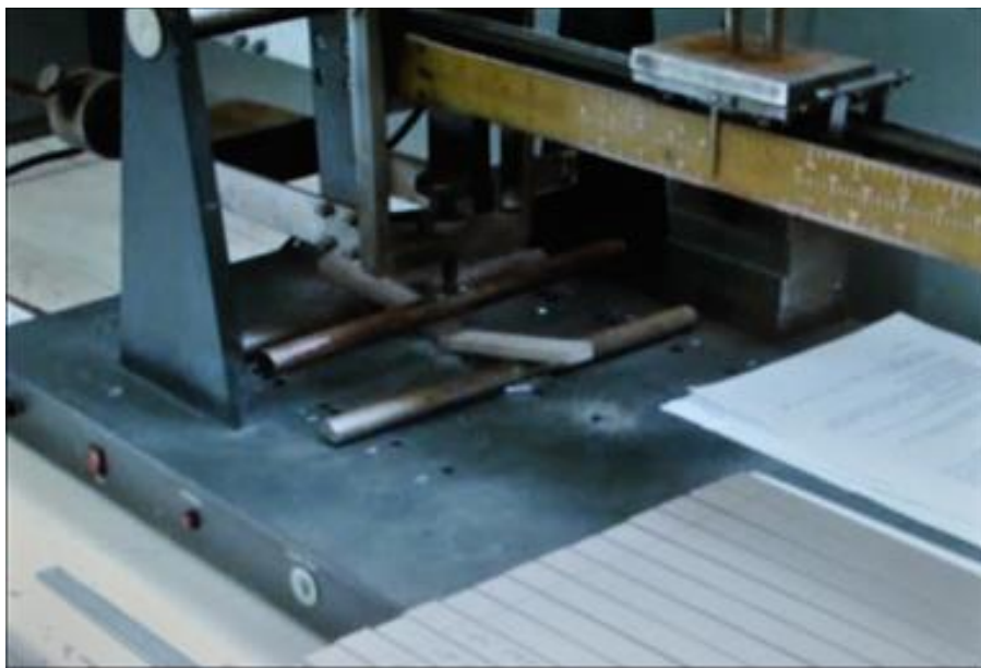
Figura 3.10 – Departamento de Qualidade: Deflectômetro. Ensaio de Resistência mecânica. Fonte: Empresa objeto do estudo, 2011.
