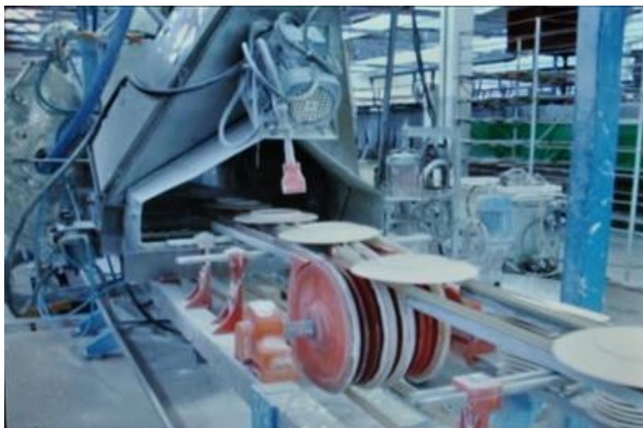
Figura 3.36 – Processo de Esmaltação: Ilustração de Esmaltação por Aspersão Automática. Fonte: Empresa objeto do estudo, (2011).
