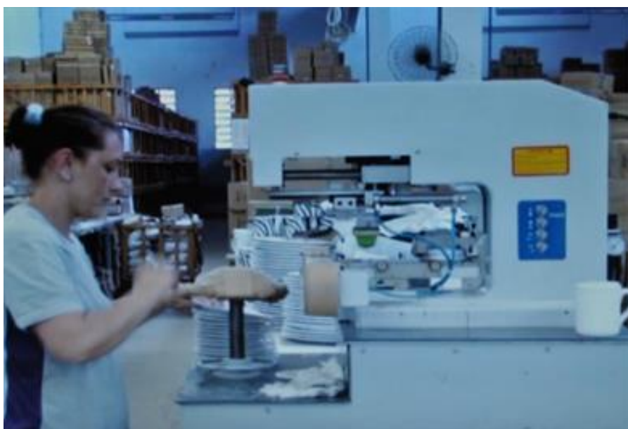
Figura 3.49 – Embalagem: Ilustração da gravação tampográfica no produto aprovado. Fonte: Empresa objeto do estudo, (2011).
