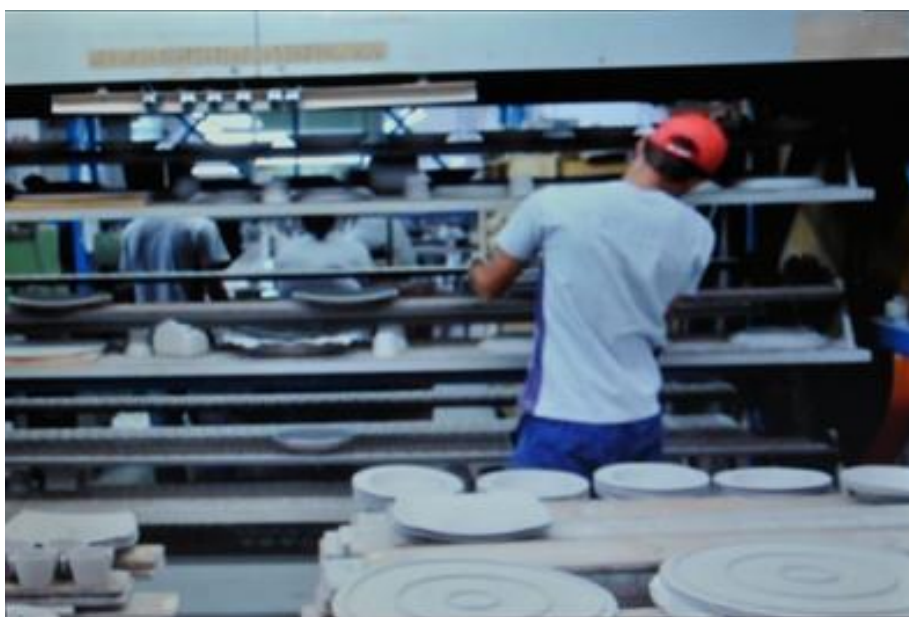
Figura 3.28 – Processo de Secagem: Ilustração da alimentação manual de peças no secador. Fonte: Empresa objeto do estudo, (2011).
