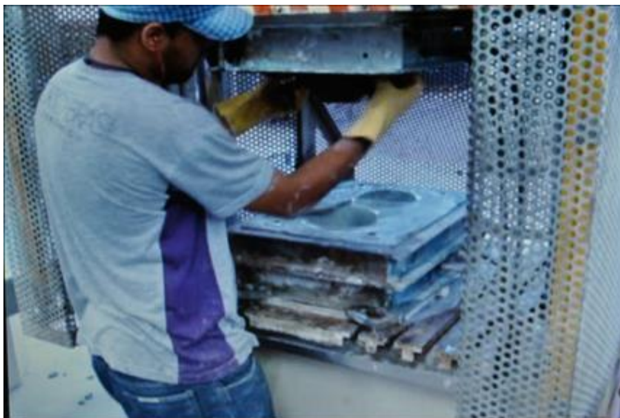
Figura 3.21 – Departamento de Conformação: Ilustração de Prensagem de uma peça redonda. Fonte: Empresa objeto do estudo, (2011).
