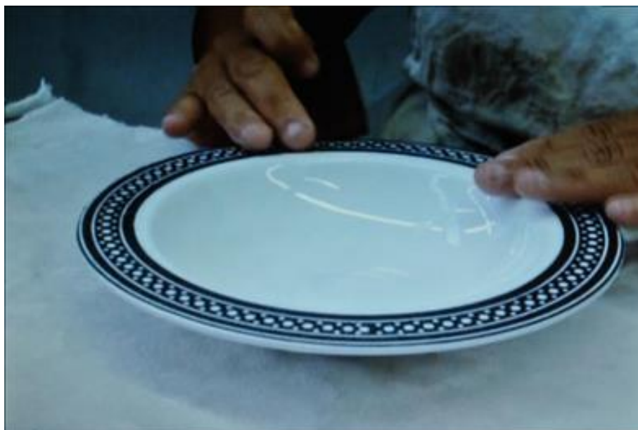
Figura 3.45 – Aplicação de Decalque: Ilustração da aplicação manual do Decalque e remoção de eventuais bolhas com um raspador. Fonte: Empresa objeto do estudo, (2011).
