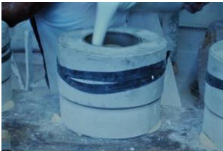
Figura 3.15 – Departamento de Modelagem e Estamparia: Fabricação do molde para fundição. Fonte: Empresa objeto do estudo, (2011).
