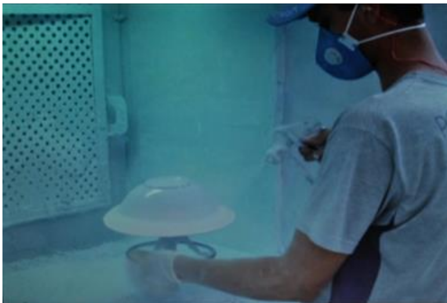
Figura 3.35 – Processo de Esmaltação: Ilustração de Esmaltação por Aspersão Manual. Fonte: Empresa objeto do estudo, (2011).
