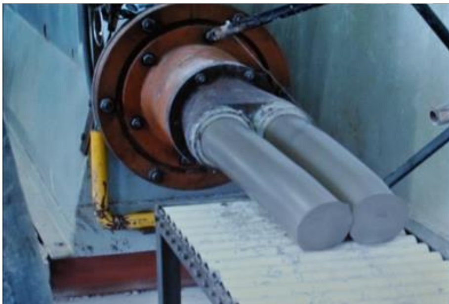
Figura 3.20 – Departamento de Modelagem e Estamparia: Material Marombado para ser usado na Prensagem e Torno Roller . Fonte: Empresa objeto do estudo, (2011).
