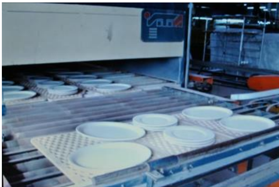
Figura 3.31 – Primeira Queima: Ilustração da saída das peças no forno. Fonte: Empresa objeto do estudo, (2011).
