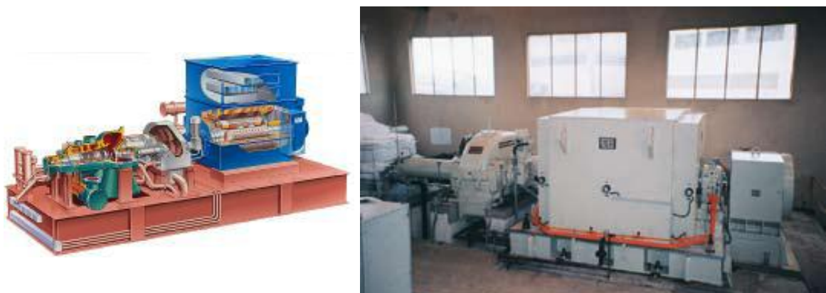
FIGURA 3.34 – Ilustração de instalação de turbogerador
