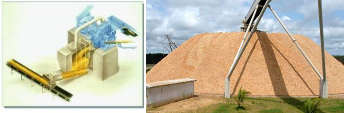
FIGURA 3.4 – Esquema da picagem e da estocagem de cavacos
