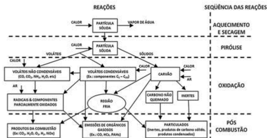
FIGURA 3.25 – Diagrama do processo de combustão de sólidos
