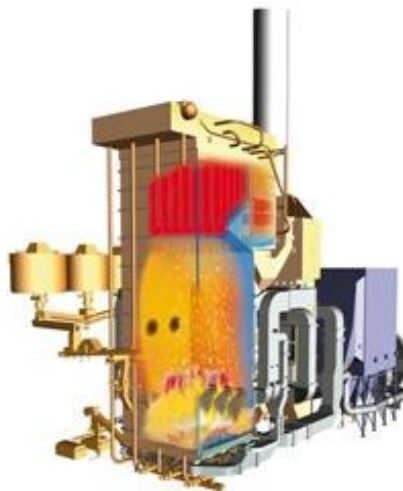
FIGURA 3.24 – Ilustração da combustão em caldeira de biomassa
