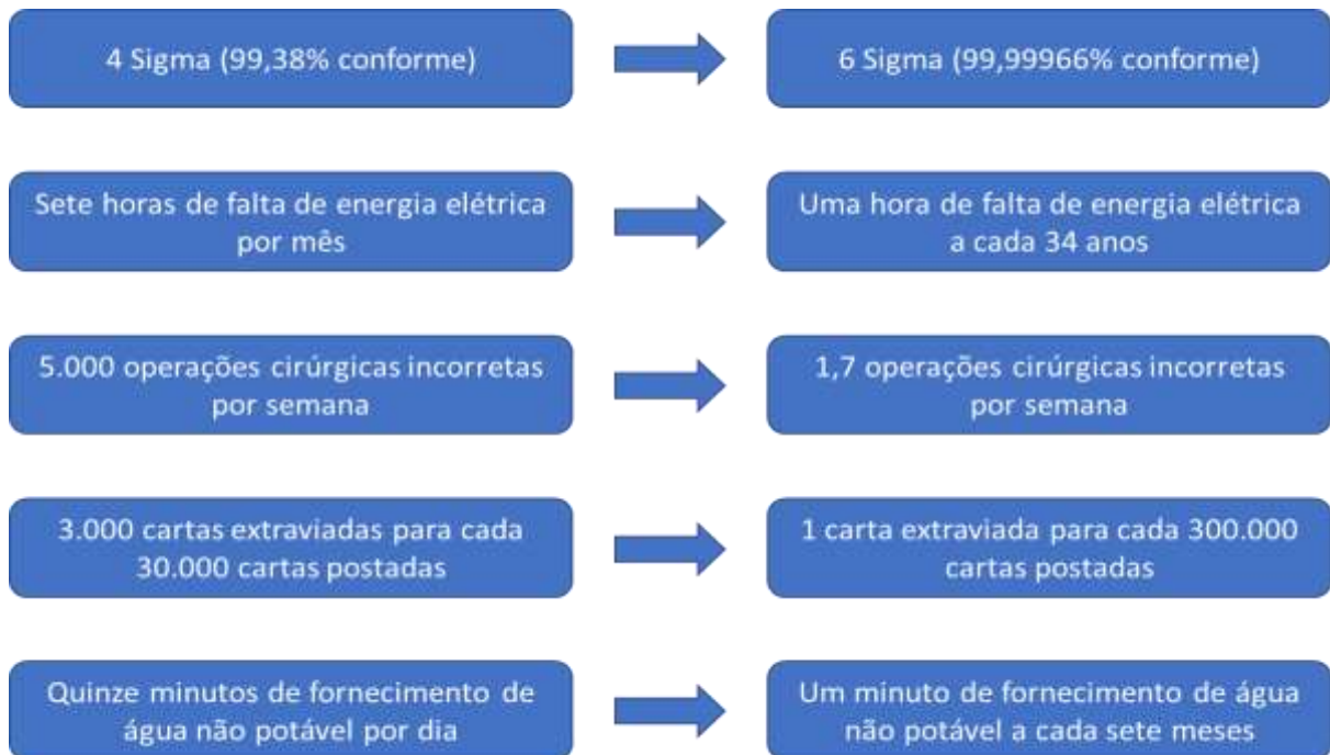
Figura 12 - Exemplos de processos operando em 4 sigma ( \sigma ) e 6 sigma ( \sigma )
