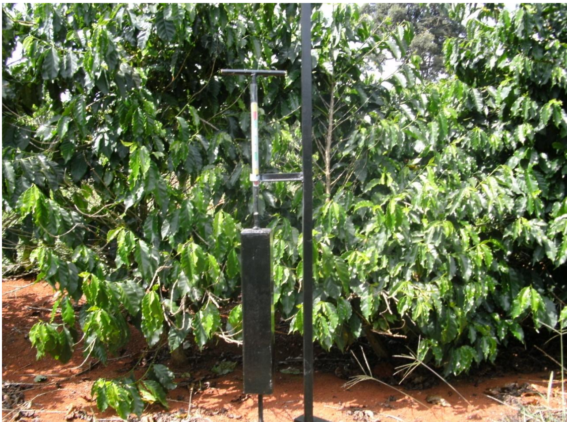
Figura 12- Uso do penetmetro em lavoura de café (sítio Capetinga). Fonte: Denis Teixeira Terra -2012.
