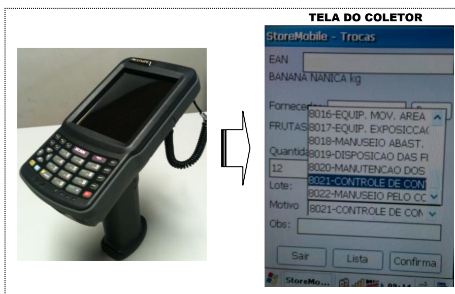
Figura 48 - Apontamento das perdas ao longo do fluxo logístico com o coletor RF
