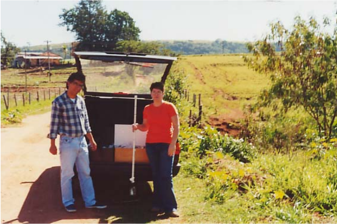
Figura C3. Preparação de frasco no coletor de água (haste) para determinação do OD.
