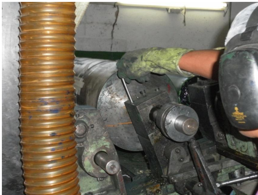
Figura 4.55 – Retirar parafusos dos mancais
