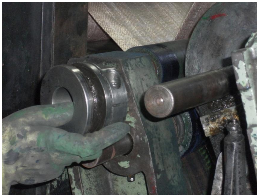
Figura 4.61 – Retirando a guia do ajuste fino de impressão
