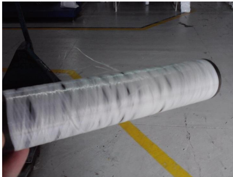
Figura 4.49 – Resíduo em excesso do tubete
