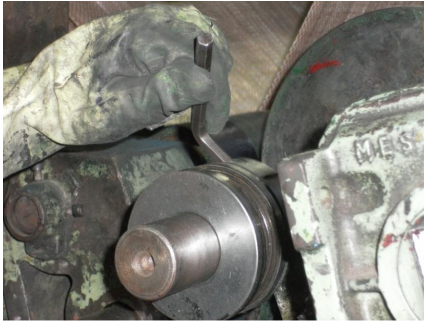
Figura 4.60 – Guia do ajuste fino de impressão
