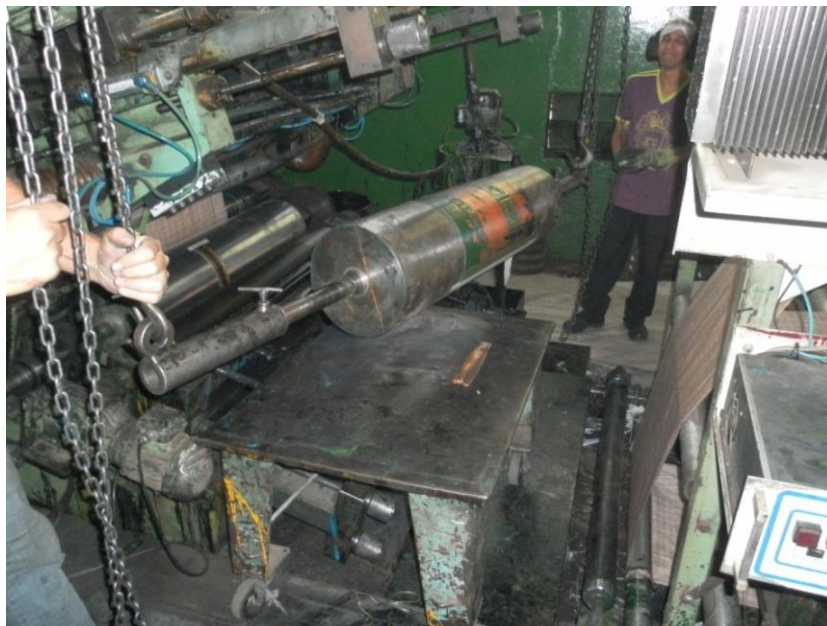
Figura 4.70 – Colocando o cilindro em cima do carrinho
