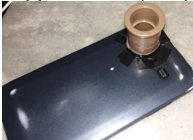
Figura 28 – Adaptação de cano PVC ao celular para realização da ovoscopia
