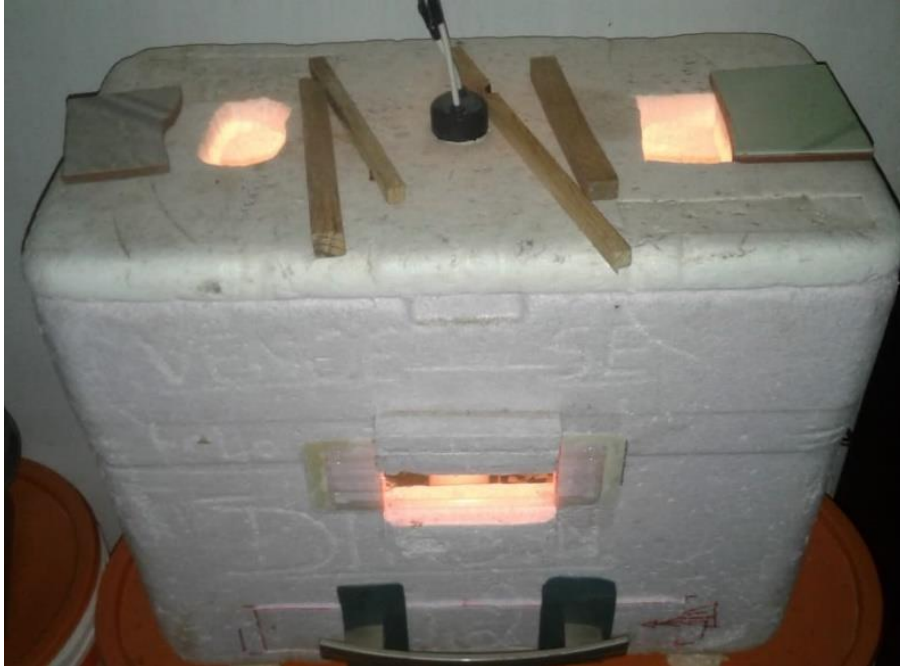
Figura 27 - Chocadeira de caixa de isopor confeccionada pelo próprio criador L7
