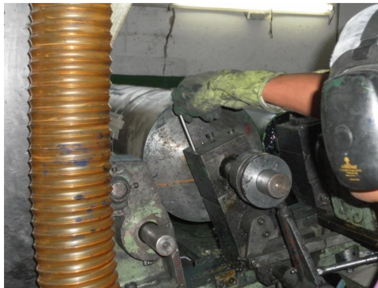
Figura 3.19 – Retirar parafusos dos mancais. Fonte: Próprio autor.
