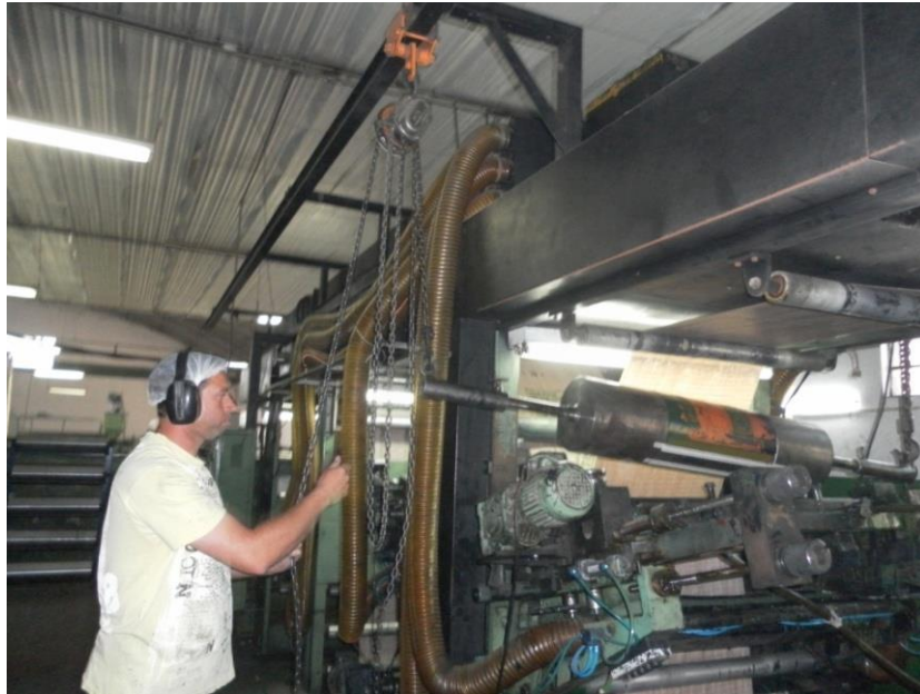
Figura 3.33 – Levantando o cilindro. Fonte: Próprio autor.
