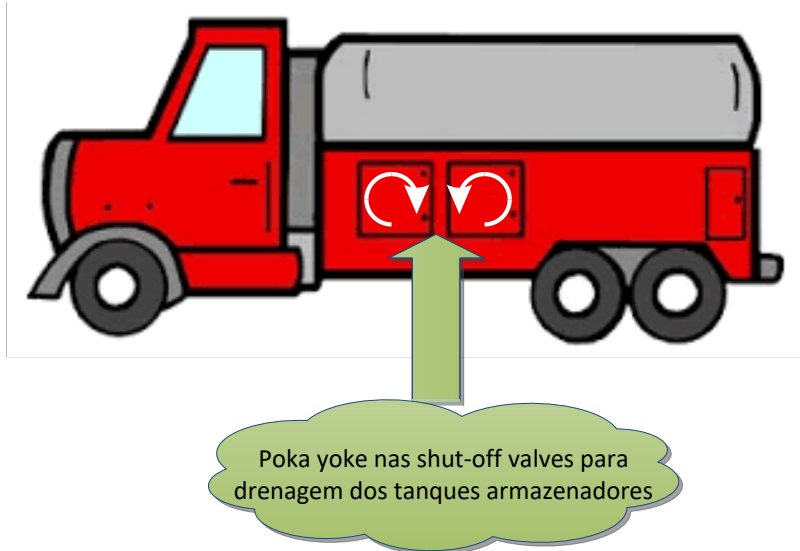
Figura 4 - Poka-yoke das válvulas SOV de descarga de matéria prima.
