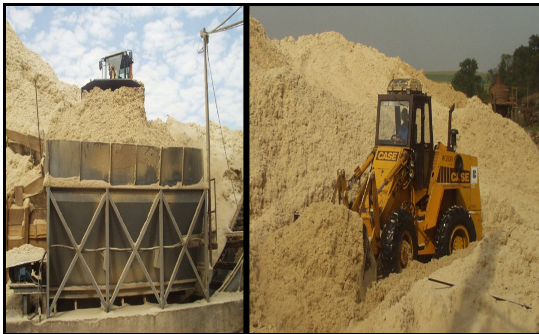
Figura 16 - Manejo do Bagaço em pá carregadeira.
