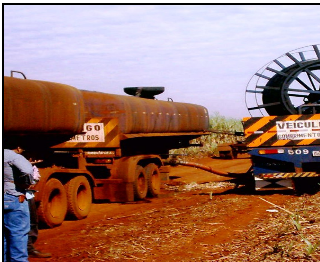
Figura 22 - Equipamento com carretel enrolador de mangueira
