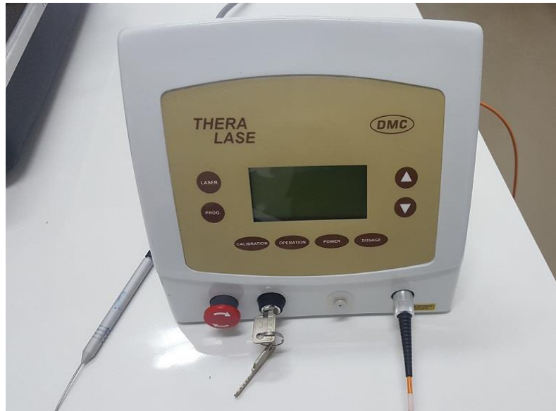
Figura 10: Equipamento contendo os diodos responsáveis pela emissão das radiações LASER nos \lambda de 685 e 830nm.
