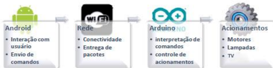
Figura 5. Esquema de funcionamento do sistema de automação residencial
